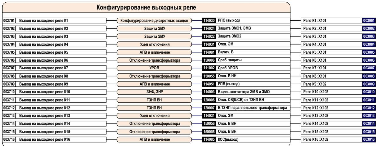
Рисунок 66 – Конфигурирование выходных реле
